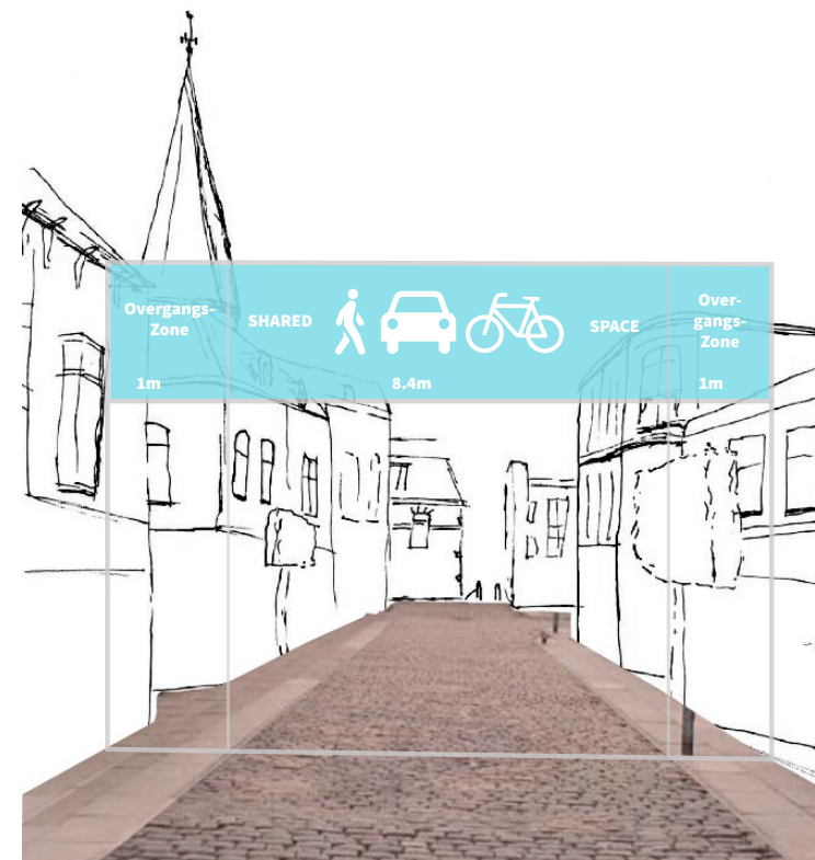
Afb. 31, gebruiken van de straat
